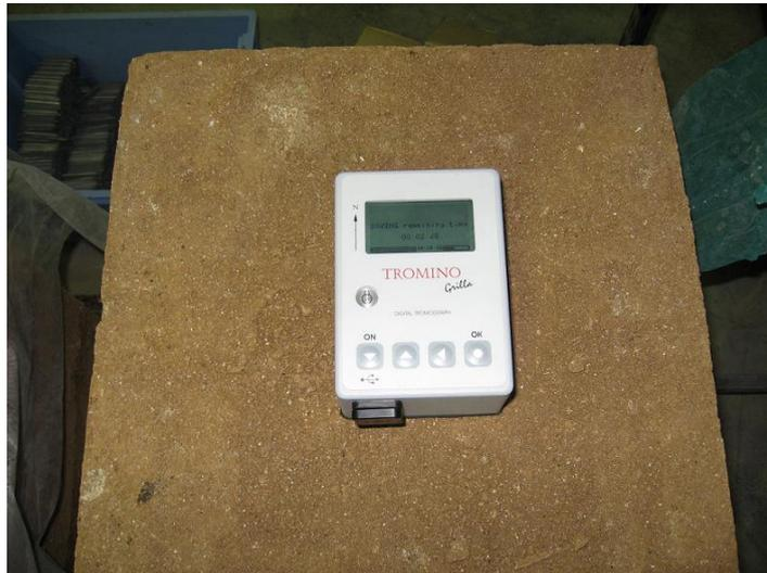
FIG. 4.1 – Vélocimètre posé sur le haut de l'échantillon
