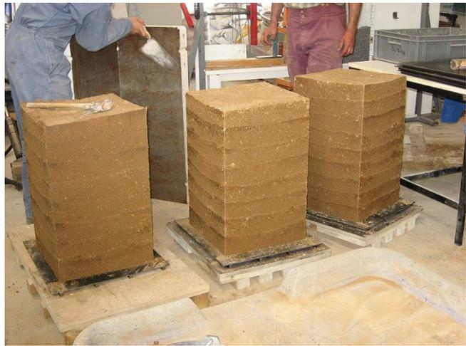
FIG. C.6 – Echantillons décoffrés
