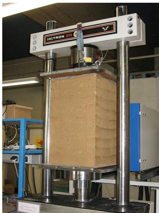
FIG. 3.2 – Echantillon de pisé sur la presse
