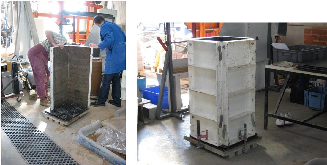
FIG. C.1 – Coffrage des échantillons
