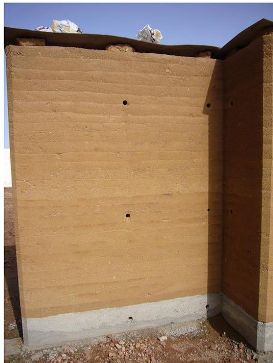
FIG. 3.1 – Photos du mur en L testé par le LGM
