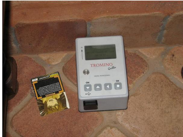
FIG. 5.3 – Vélomètre posé au rez-de-chaussée de la maison
