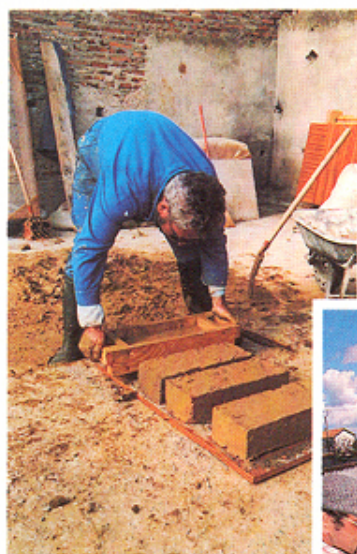
Fabrication de briques en terre crue (adobes) en région toulousaine. (Photo Inventerre)
